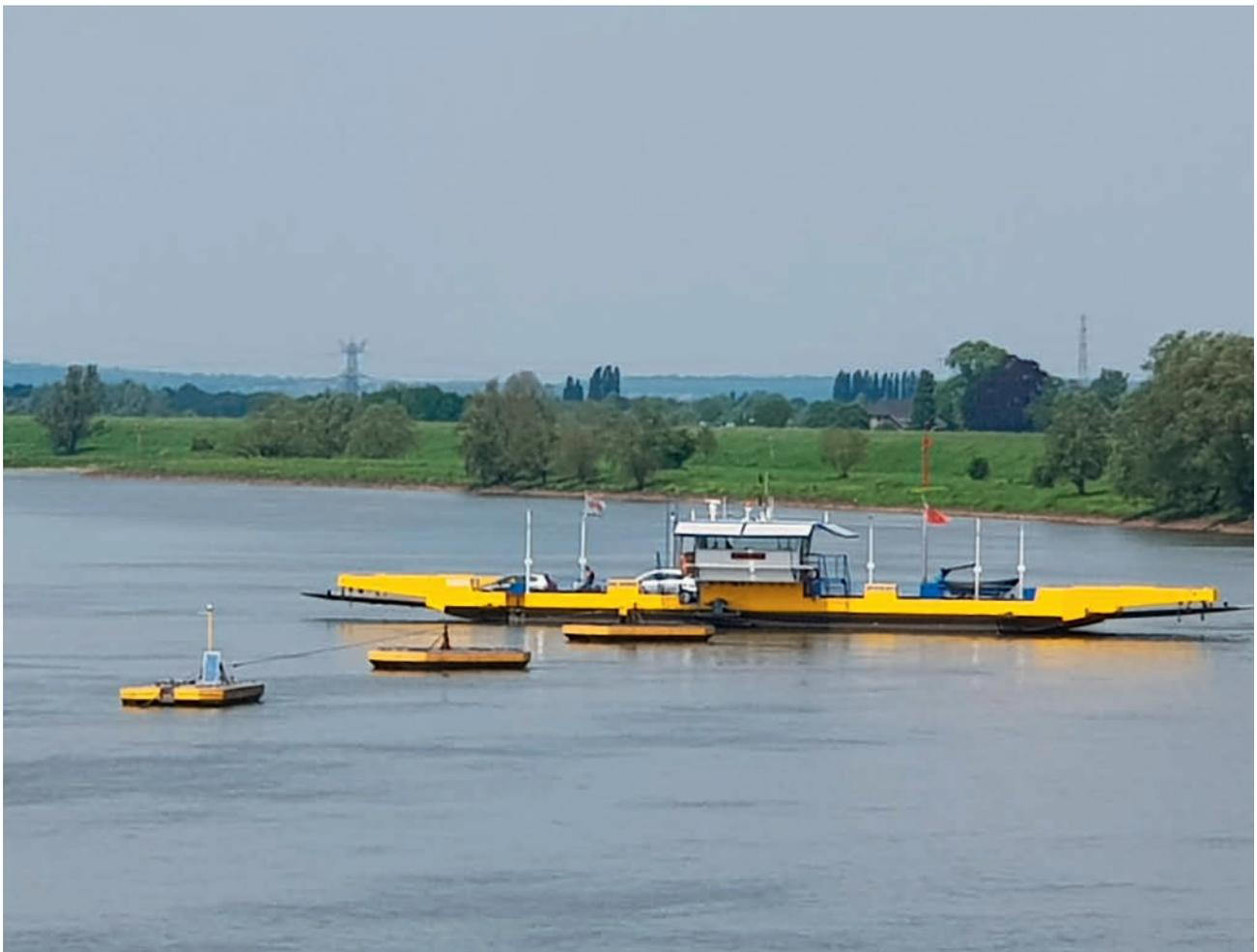
der Ankerleine). In der Strommitte erreicht die Geschwindigkeit ein Maximum. Zum anderen Ufer hin wird sie langsamer und hat gerade soviel Antrieb, dass sie genau überkommt und mit der heruntergelassenen Rampe die Autos auf- und abfahren lassen kann.
